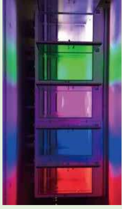
▲パラメーターフル制御栽培システム。赤、緑、青など種類が異なる光をあて、温度、湿度などさまざまな栽培条件を再現して実験ができます。
